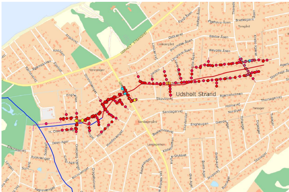
Figur 5: Oversigtskort over spildevandsledninger, vandledninger, fælleskloakledninger samt trykledninger, hvor Gribvand A/S er ledningsejer. Rørlagt vandløb (rød streg), spildevandsledning og knudepunkt (stiplet rød streg, rød cirkel), vandledning og knudepunkt (stiplet lyseblå streg, lyseblå cirkel) og fælleskloakledning (gul stiplet streg, gul cirkel) og trykledning samt knudepunkt (pink stiplet streg, pink cirkel).
